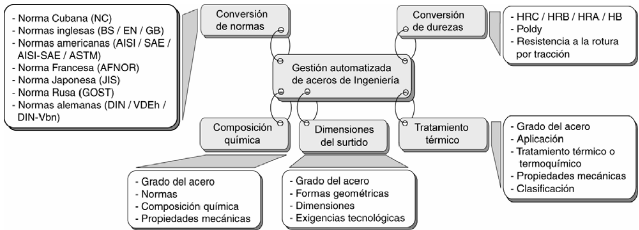
Figura 1. Tablas y elementos fundamentales del gestor de bases de datos de aceros de Ingeniería.
